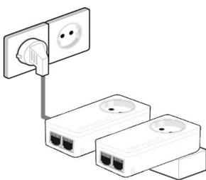
Il y a un méthode très simple pour vérifier si les deux adaptateurs communiquent entre eux: Branchez les deux adaptateurs côte à côte sur une multiprise. Raccordez maintenant la multiprise au secteur. Si les deux adaptateurs forment un réseau, la DEL CPL (selon le produit utilisé
